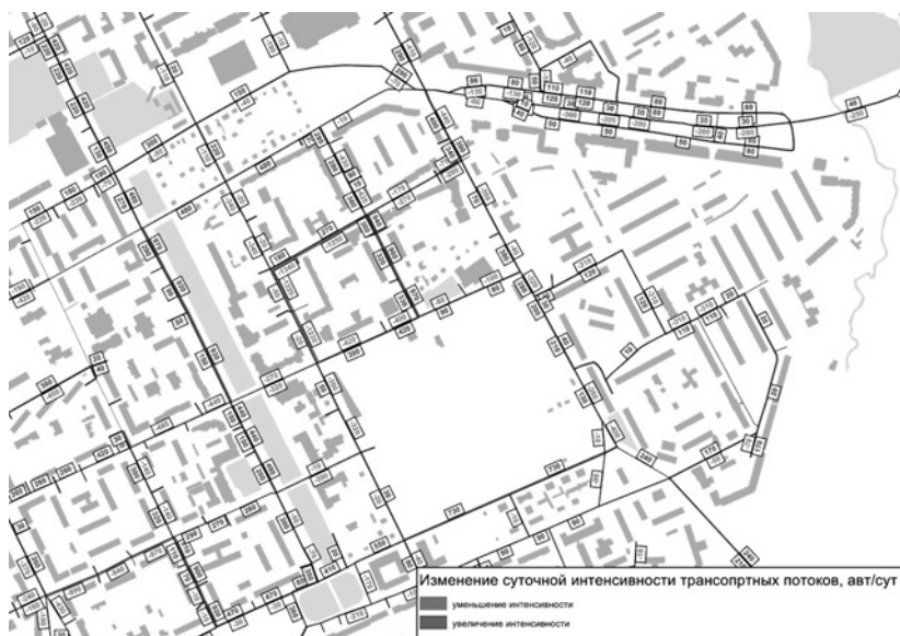
Рис. 102. Картограмма разностей прогнозной и существующей интенсивностей движения транспортных потоков в исследуемой области
