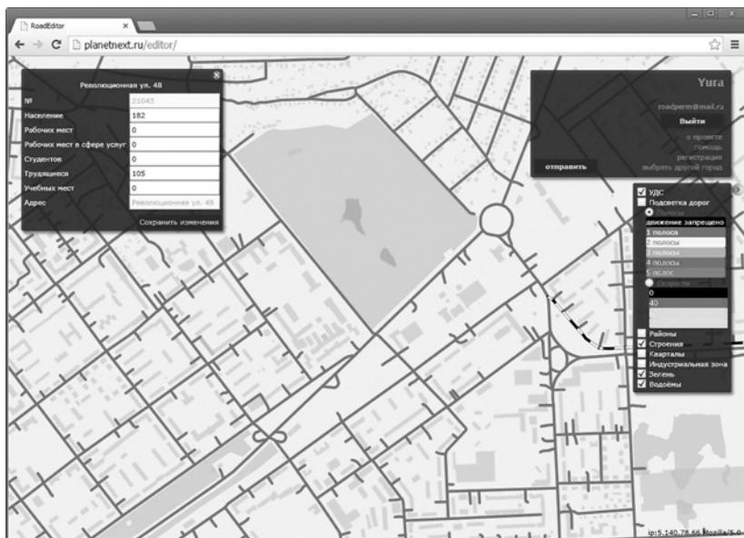
Рис. 63. Редактирование исходных данных для расчета транспортного спроса в г. Самара на ресурсе http://planetnext.ru/editor/
